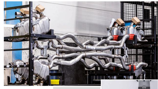
Medienführende Bauteile, Baugruppen oder komplexe Abgasanlagen stehen bei PTS im Vordergrund. Kleinserien gehen in den Rennsport, größere Serien fertigt PTS für die Kfz- und Nutzfahrzeugindustrie:
